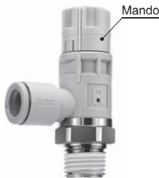
2. Al realizar el trabajo de conexionado, gire la herramienta de apriete en sentido horizontal hacia las partes planas hexagonales del cuerpo B para evitar la aplicación de momento sobre el cuerpo A. Si la herramienta está en contacto con el cuerpo A, el cuerpo B puede salirse.
