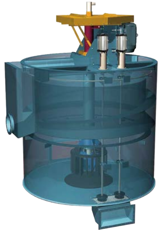
▲ Celda de flotación / Flotation tank
